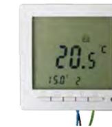
Der Thermostat mit Wochenprogramm ist für die Montage in einer Standard UP-Dose Ø min. 55 mm konstruiert. Der Sensor misst die Raumtemperatur und schaltet bei Unterschreitung der Solltemperatur den Stellantrieb/elektr. Heizung (max. 16 A) an.
